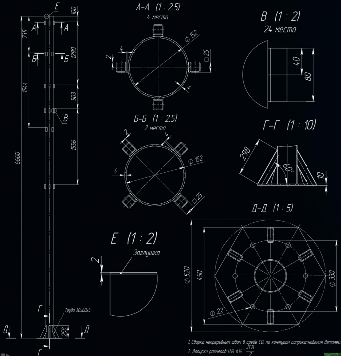
1. Сварка непрерывным швом в среде СО<sub>2</sub> по контурам соприкосновения деталей.
